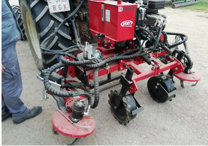
Xassís multifuncional amb grada rotativa o segadora de fils
