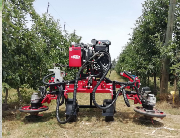
Xassís multifuncional amb grada rotativa o segadora de fils
