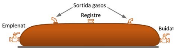
Figura 4. Connexions de la bossa flexible de purins.
