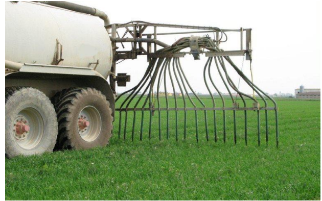
Imatge 2. Aplicació de purí de porc amb sistema de distribució de mànegues sobre cereal d'hivern a l'experiment de regadiu de Castelló de Farfanya. Font: Oficina de Fertilització – DARP.
