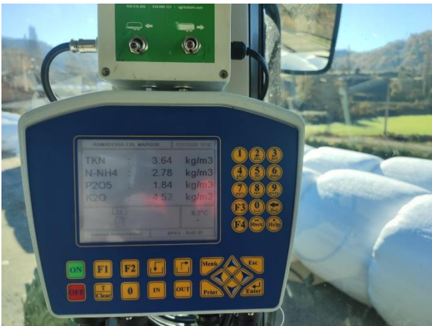
Figura 8. Lectura de la conductivitat en continu amb un equip instal·lat a la cisterna. Font: DARP
