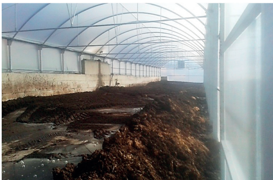
Figura 3.3.2. Imatge superior: Planta d'assecatge solar per al tractament dels purins d'una granja mixta de porcí i de vaquí, que consta d'una zona de càrrega i acidificació del purí (A), tanc d'emmagatzematge d'àcid sulfúric (B), hivernacle (C) i màquina desencrostantora (D). Imatge inferior: Planta d'assecatge solar de la fracció sòlida de purins d'una granja de porcs d'engreix.
